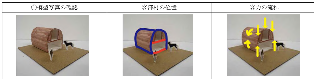
図 1 犬小屋（フォーム構造システム）
